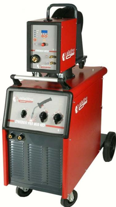
Ce générateur triphasé peut souder à fil l'acier, l'acier inox et l'aluminium. Il peut être utilisé avec des **dévidoirs d'alimentation traditionnels à 2 ou 4 galets**, modèle **WF20 ou WF40**, et avec le dévidoir synergique à **4 galets**, modèle **WF44**.
